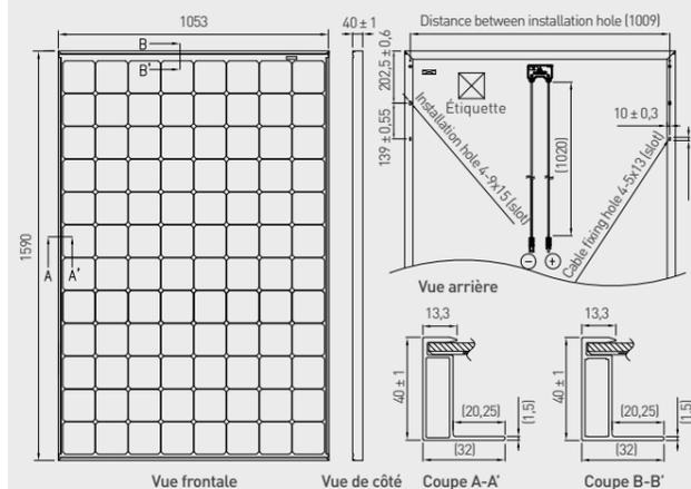
La plage de fixation doit être comprise entre 1030 et 1230 mm.
