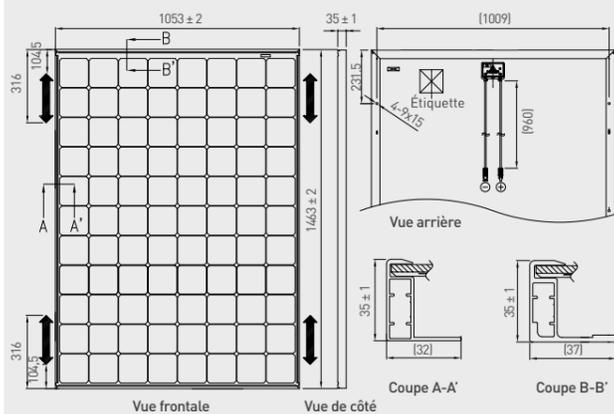
La plage de fixation doit être comprise entre 836 et 1200 mm.
